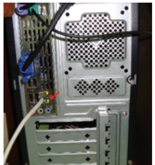
Fig 5. Cable de red conectado a un CPU
